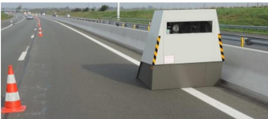
Transporté au moyen d'une remorque, ce radar est facilement déplaçable sur des zones de danger, derrière les balises d'un chantier, sur un terre-plein central, en accotement ou sur trottoir. Il dispose d'une autonomie en batteries d'une semaine.
